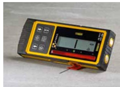
**Marca de señalización** abatible para colocar con precisión el receptor.
