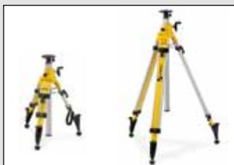
Trípode de construcción con columna de elevación con amortiguación neumática, tope de extensión y cierre rápido. Patas del trípode con puntas y tapones de goma dura giratorios. Rosca  $\frac{3}{8}$ ".
