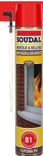
Espuma de isolamento à base de poliuretano (PU) com excelentes propriedades térmicas e acústicas, mas também como retardante de fogo em caso de incêndio (classe B1, de acordo com a norma DIN 4102), graças às suas propriedades ignífugas. Resistente a temperaturas máx. +100°C. Poder de isolamento: +/- 0,04 W/m.K.
