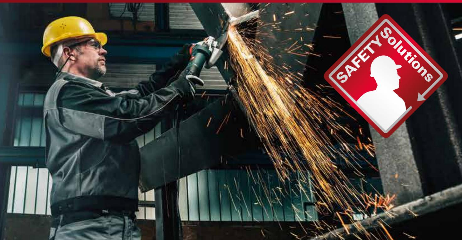
**RIESGO: ruptura y quebradura de discos**
