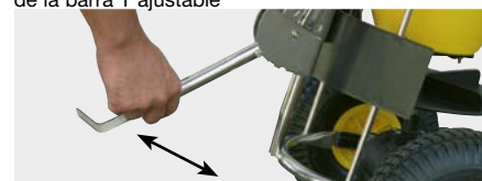
Pie de apoyo con bisagra
