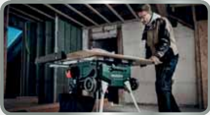
Peças de trabalho de grandes dimensões não representam qualquer problema Altura de corte 87 mm, largura de corte 630 mm na paralela (TS 36 LTX BL 254, TS 36-18 LTX BL 254 e TS 254)
