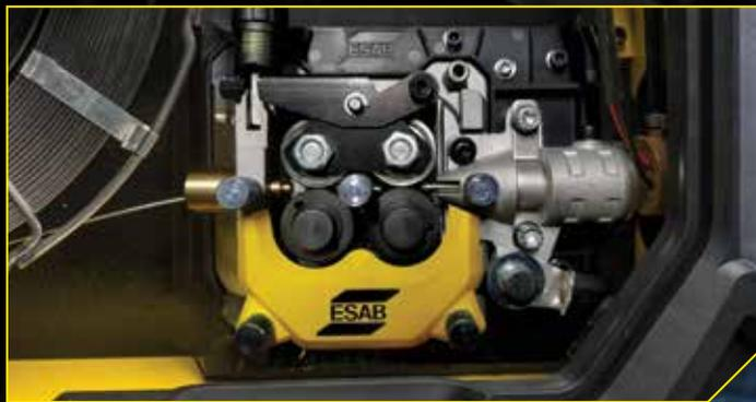
Sistema de acionamento de 4 cilindros e velocidade de alimentação do fio de 20,3 m/min para um desempenho de alimentação positivo com todos os diâmetros de fio.
