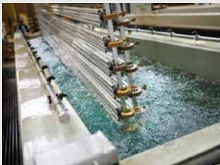
Bañera de galvanizado de polipropileno © Collini www.collini.eu
