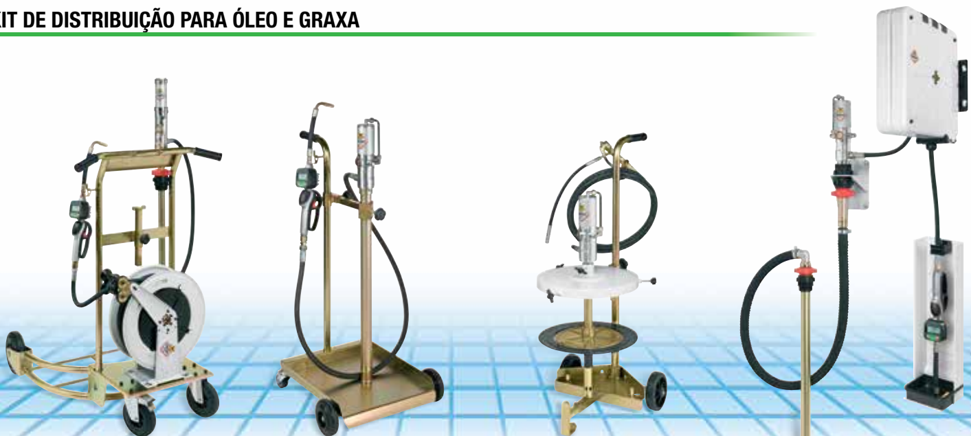
Plataformas móveis para distribuição do óleo com bomba R 3:1 - 5:1 pistola conta-litros e enrolador de mangueira
