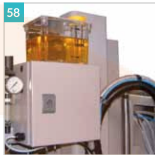
000947 Sistema lubrificação mínima 1.3 litros
