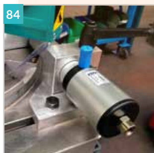
689000 Pressão para Sirio cortar a 45°
