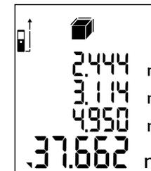
**2. Realización de la medición:** medir una habitación con la función de medición "Volumen". Resultado en metros cúbicos.
