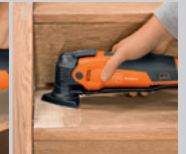
Lijado en esquinas y bordes sin rebote.
