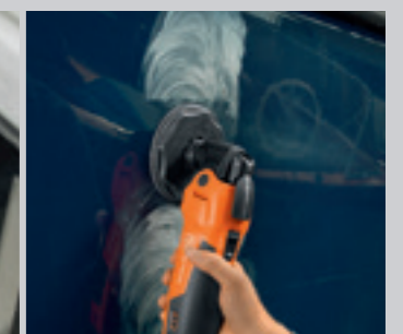
Eliminación de rayaduras en pinturas de vehículos con el pad de pulido de fieltro y productos de pulido.
