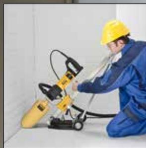
**REMS Picus DP – Caroteamento sem água com tecnologia de micro-impulsos. Limpo, simples, rápido, p ex. 200 mm em betão armado com Ø de 62 mm apenas 5 min.**
