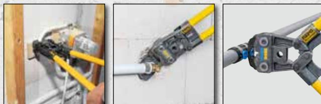
**Dispositivo de acionamento REMS Eco-Press**
