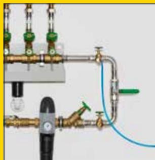
Verificação da pressão e da estanqueidade com ar comprimido (SL/SLW)
