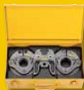
REMS matrizes (PR-3S) com 3 segmentos de prensar assentes num anel de rotação articulado. Para compressões exigentes de grandes dimensões. Compressão ideal graças ao movimento de comando radial dos segmentos de prensar. Contorno de prensar M para sistemas "pressfitting" Geberit Mapress e outros sistemas adequados.
