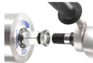
4 Anilha de desengate rápido, para desenroscar a coroa do encaixe do motor
