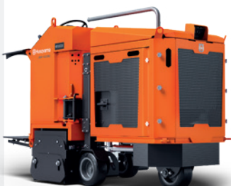
ELÉTRICA HUSQVARNA BMP 4000RC Telecomandada 30 kW, 400V/63 A, 3-phase, 400 mm largura de trabalho, 1550 kg.
