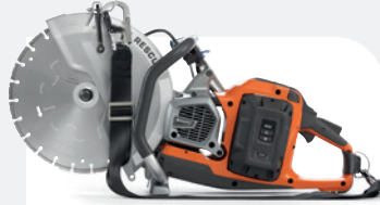
CORTADORA HUSQVARNA K 1 PACE RESCUE 7.9 kg, tamanho do disco 350 mm, profundidade de corte 144.5 mm.
