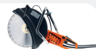
HIDRÁULICA HUSQVARNA K2500 150 bar/40 l/min, 5,2 kW, 8,3 kg, disco 400 mm, profundidade de corte 145 mm.
