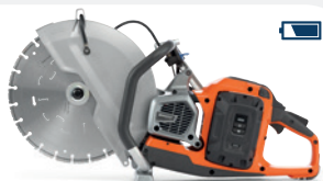
ALIMENTADO POR BATERIA HUSQVARNA K1 PACE 7,2/7,4 kg, disco 300/350 mm, profundidade de corte 121/144,5 mm. Sistema de baterias PACE 94 V.
