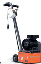
ELÉTRICA HUSQVARNA BMP 215 1,8 kW, 230V/16 A, 1-phase, 215 mm largura de trabalho, 63 kg.
