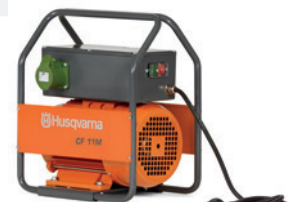
ELÉTRICO HUSQVARNA CF 11 Potência 42 V–3–200 Hz, 0,8 kVA, 11A, 18 kg, 1 tomada.
