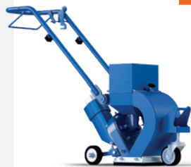
ELÉTRICA HUSQVARNA BLASTRAC 1-7D 2.4 kW, 110/230 V, 16 A, velocidade manual, largura de trabalho 203 mm, 54 kg.
