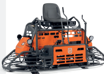
GASOLINA HUSQVARNA CRT 48 Ideal para o acabamento de superfícies de 1000-1900 m². Com um sistema de direção mecânica superior e uma relação peso-potência equilibrada. 27.6 kW, 2×1220 mm, 579 kg.
