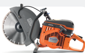
ALIMENTADO POR GASOLINA HUSQVARNA K970 94 cc, 4,8 kW, 11/11,6 kg, disco 350/400 mm, profundidade de corte 125/155 mm.
