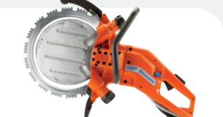
HIDRÁULICA HUSQVARNA K3600 MK II 150 bar/40 l/min, 4,3 kW, 8,3 kg, disco 370 mm, profundidade de corte 270 mm.
