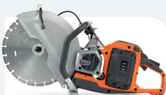
CORTADORA HUSQVARNA K 1 PACE 7.2/7.4 kg, tamanho do disco 300/350 mm, profundidade de corte 121/144.5 mm.
