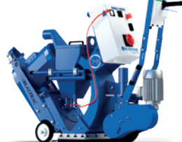
ELÉTRICA HUSQVARNA BLASTRAC 1-10DPS75 7.5 kW, 400 V, 16 A, velocidade 0.5-30 m/min, largura de trabalho 254 mm, 211 kg.
