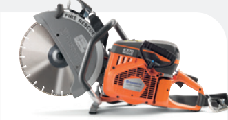
ALIMENTADO POR GASOLINA HUSQVARNA K970 RESCUE 94 cc, 4,8 kW, 11 kg, disco 350 mm, profundidade de corte 125 mm.
