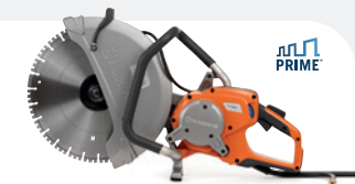
ELÉTRICA HUSQVARNA K7000 230/400 V, 5,5 kW (3-phase)/3 kW (1-phase), 9,8 kg, disco 400 mm, profundidade de corte 155 mm.
