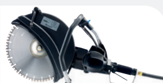
PNEUMÁTICA HUSQVARNA K40 7 kp/cm², 3,2 kW, 9,9 kg, disco 350 mm, profundidade de corte 125 mm.
