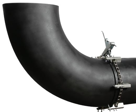
O grampo de corrente simples tipo 2500S é uma ferramenta fácil para soldar tubo a tubo, tubo a curva, tubo a T ou tubo a flange. O baixo peso torna fácil a sua utilização na oficina ou no estaleiro de obra.
