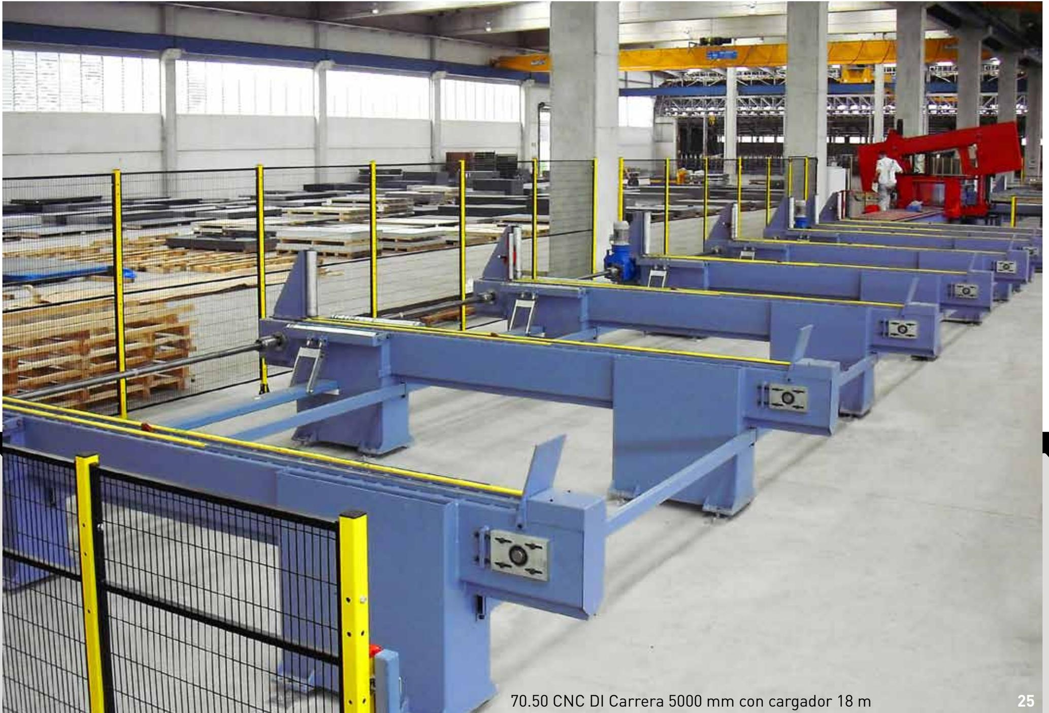
70.50 CNC DI Carrera 5000 mm con cargador 18 m
