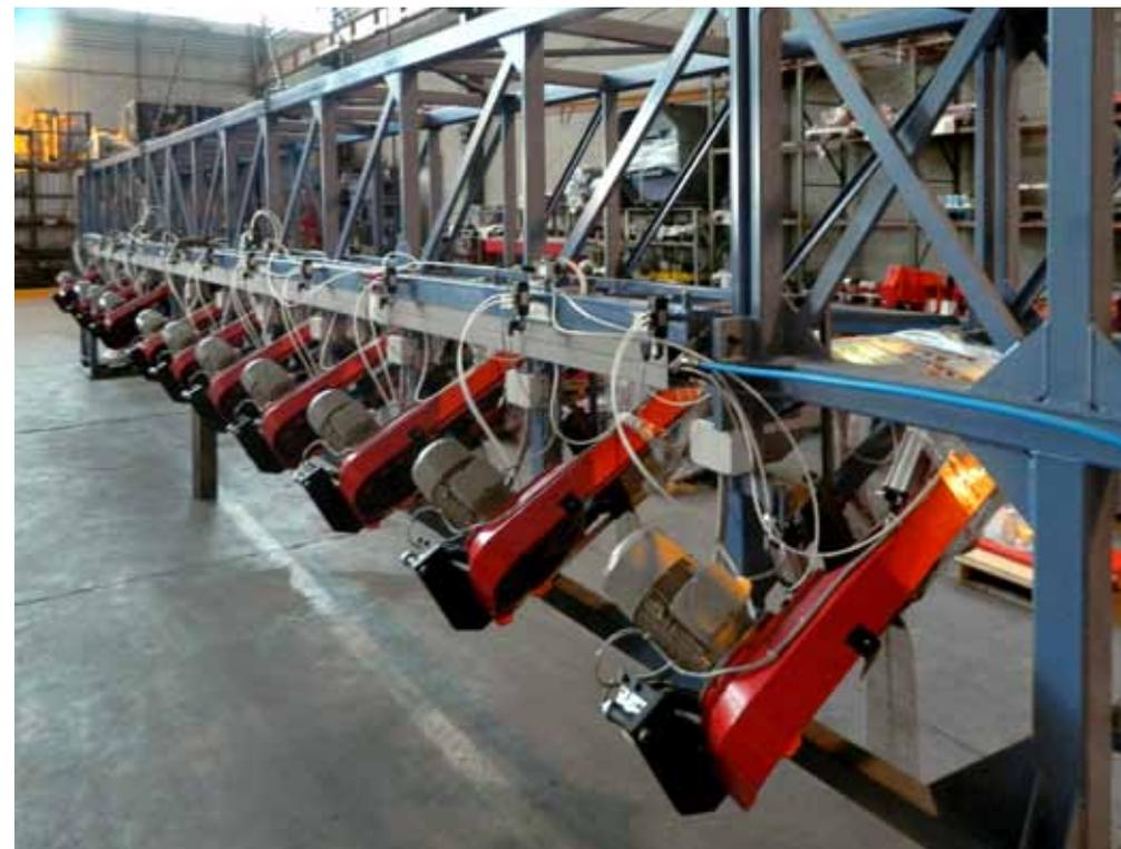
12 cabezales automáticos para el corte D.10 a 120 mm de 1 a 12 m
