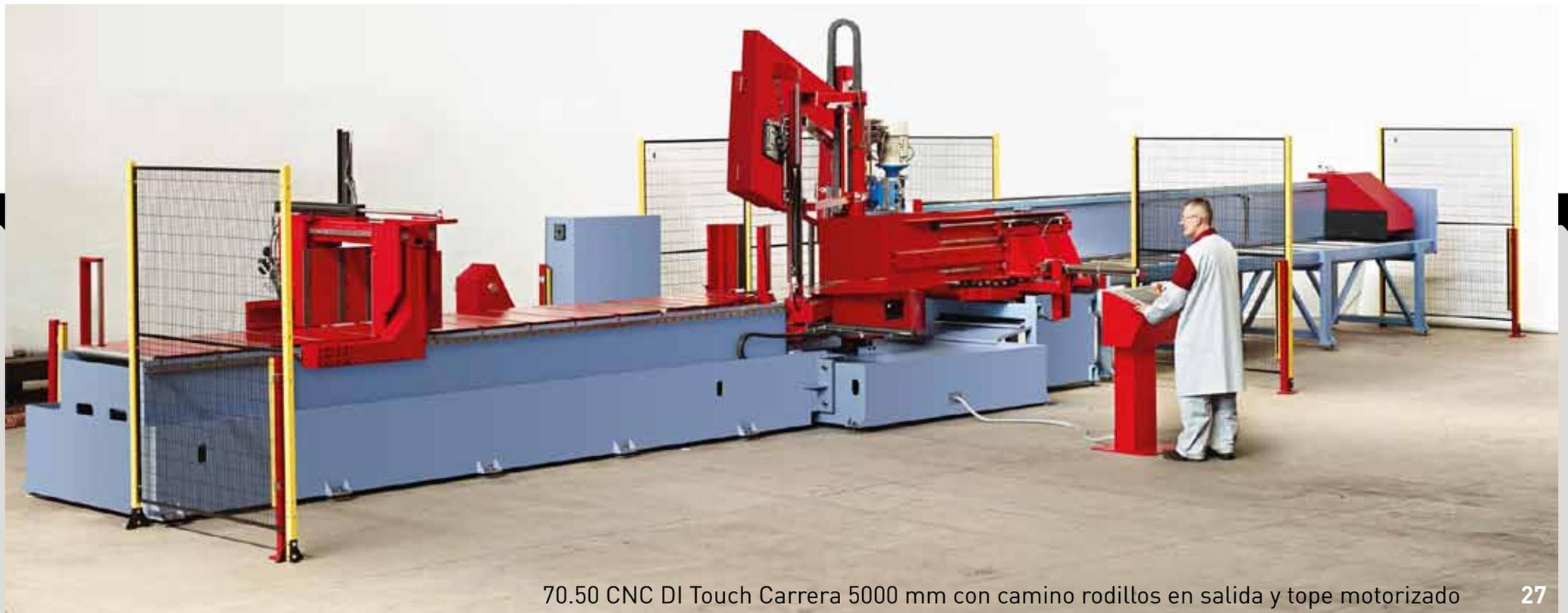
70.50 CNC DI Touch Carrera 5000 mm con camino rodillos en salida y tope motorizado
