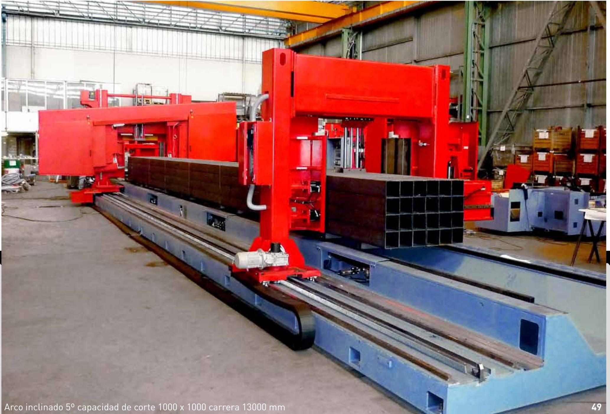
Arco inclinado 5° capacidad de corte 1000 x 1000 carrera 13000 mm
