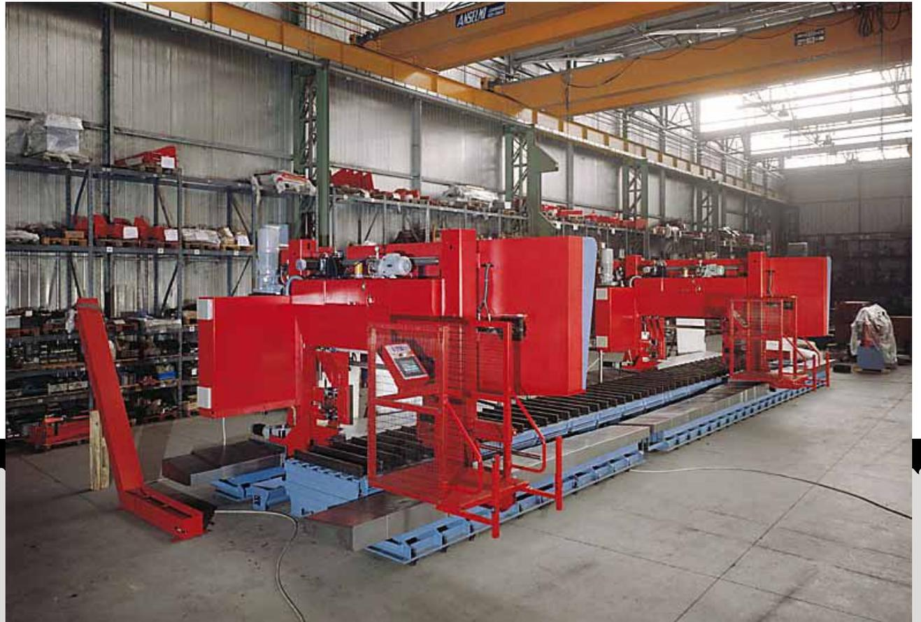
1250 doble cabezal carrera 15000 mm
