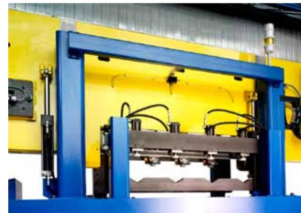
Línea de corte para materiales en colada continua camino de rodillos de 24 metros y descarga lateral.
