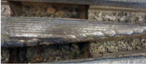
P5 para fundição de cróssimas de manganês austenítico
