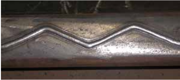
P4 para fio Ss com padrão em ziguezague para condutividade
