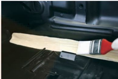
Acabamento pincelado utilizando um pincel na selagem
