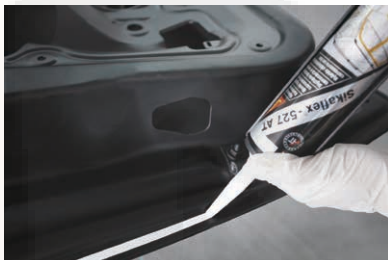
Selagem por cordão utilizando o bico standard
