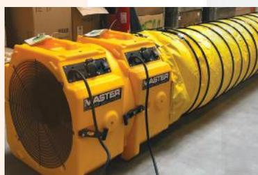
Duas unidades conectadas para aumentarem a pressão do ar, e desta forma aumentarem a distância da conduta ligada ao ventilador.
