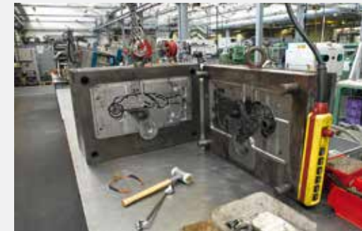
Construcción de moldes
