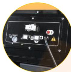
Panel de control con conector para termostato remoto opcional (analógico o digital)
