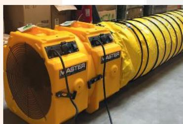
Dos unidades conectadas para aumentar la presión de aire, y de esta manera aumentar la distancia de conducto conectado al ventilador.
