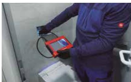
Módulo TEC indicado para a inspeção de espaços vazios e áreas de difícil acesso.
