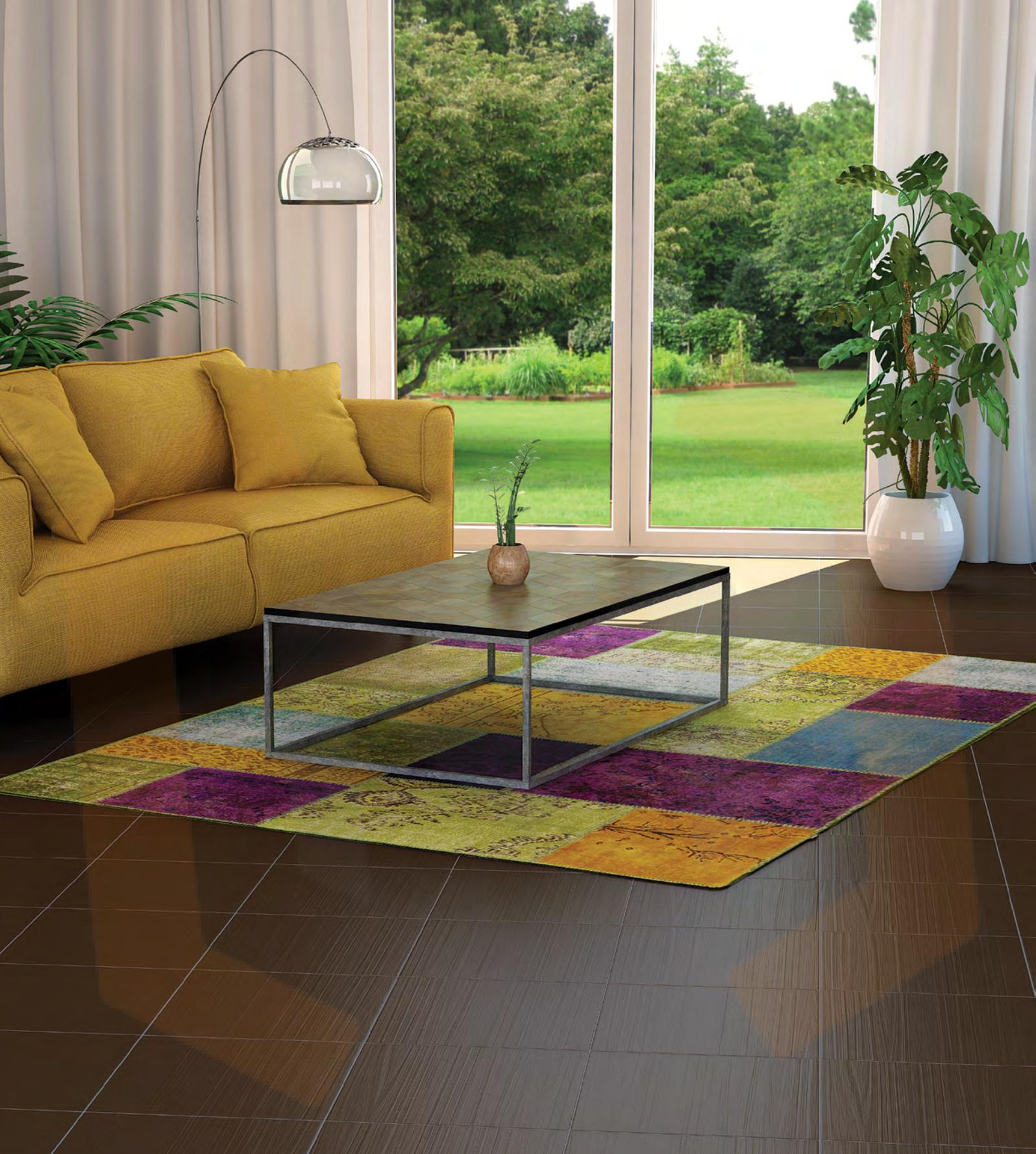
O grés porcelânico é um revestimento cerâmico de elevada durabilidade, uma vez que é produzido sob pressões e temperaturas elevadas, o que o torna extremamente resistente e não absorvente. Por isso, frequentemente, este tipo de revestimento é escolhido pelos donos de obra que valorizam o desempenho e fiabilidade, tanto em áreas residenciais como em áreas públicas.
