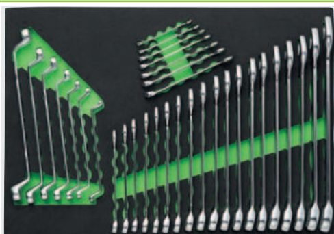
-FG 100/03M: Módulo de chaves combinadas poligonais e dupla curvatura
