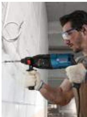
790 W, 2,7 J. 0-4.200 ipm. Bucha SDS plus. Máx. perfuração em betão: 24 mm. Velocidade variável. Rotação reversível. Bloqueio de rotação para cinzelar. 2,8 Kg.
