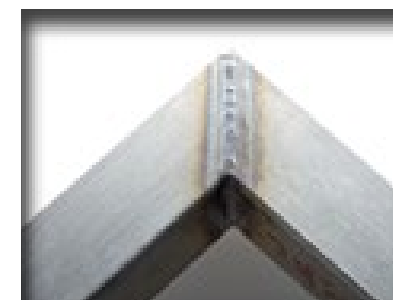
Cordón de soldadura WIG.
