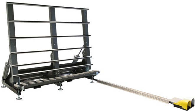
Tavolo per il ribaltamento di ante e telai da linea orizzontale/verticale e viceversa Bench to tilt sashes and frames from horizontal to vertical line and vice versa
