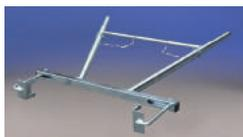
Ideal para tarefas que requerem separar a escada da parede. Permite ao operário trabalhar a uma certa distância da parede e ao mesmo tempo proporciona um apoio estável e seguro na escada. Fácil de usar, serve para qualquer escada de perfil máximo 84 mm. Indicado para realizar tarefas de pintura e limpeza. Separação mínima: 38 cm
