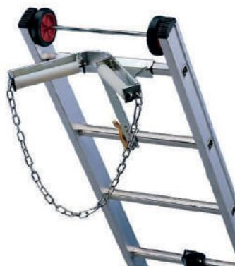
Acessório universal construído para permitir um melhor apoio e deslizamento sobre postes, árvores ou colunas. Rodas de apoio em nylon e corrente de segurança. Inclui parafusos de fixação. Distância obrigatória 28 cm. Acessório utilizável em escadas extensíveis.
