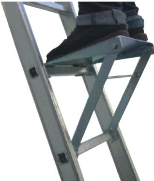
Antideslizante fabricada em alumínio. Plataforma universal para colocar sobre qualquer escada, cujo degrau seja de secção entre 25 e 30 mm e com uma distância entre degraus de 250 a 300 mm. Medida: 256x265 mm
