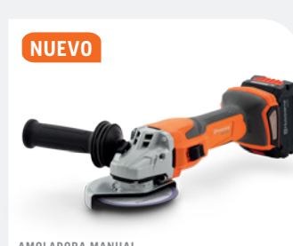
NUEVO AMOLADORA MANUAL HUSQVARNA HG 125 B Equivalente a 1500 W, ancho de pulido 125 mm, velocidad del disco 11000 rpm, 2,2 kg (sin batería). Compatible con todas las herramientas y cargadores Bosch Professional de 18 V tanto nuevos como existentes.
