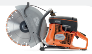
GASOLINA HUSQVARNA K 770 / K 770 WITH OILGUARD 74 cc, 3,7 kW, 10/10,1 kg, tamaño de disco 300/350 mm, profundidad de corte 100/125 mm.
