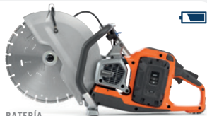
BATERÍA HUSQVARNA K 1 PACE 7,2/7,4 kg, tamaño de disco 300/350 mm, profundidad de corte 121/145 mm. Sistema de batería PACE de 94V.
