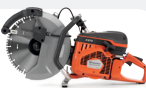
GASOLINA HUSQVARNA K 970 SMARTGUARD 94 cc, 4,8 kW, 11,9/12,8 kg, tamaño de disco 350 /400 mm, profundidad de corte 125 /155 mm.
