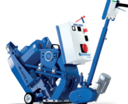
ELÉCTRICO HUSQVARNA BLASTRAC 1-8DPS55 5,5 kW, 400 V, 16 A, velocidad de trabajo 0,5–23 m/min, ancho de trabajo 203 mm, 154 kg.
