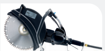
NEUMÁTICO HUSQVARNA K 40 7 kp/cm², 3,2 kW, 9,9 kg, tamaño de disco 350 mm, profundidad de corte 125 mm.
