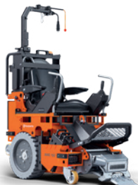
ELÉCTRICO HUSQVARNA BMS 150 Conductor sentado, 2,2 kW, 230V/16 A, 480 kg.
