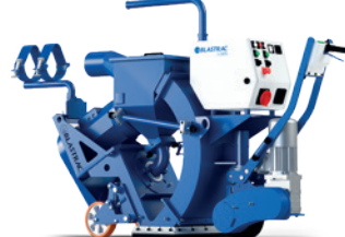
ELÉCTRICO HUSQVARNA BLASTRAC 1-15DS 15 kW, 400 V, 63 A, velocidad de trabajo 0,5–25 m/min, ancho de trabajo 380 mm, 450 kg.
