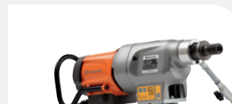
ELÉCTRICO HUSQVARNA DM 430 3200 W, monofásico, diámetro de broca recomendado 100-450 mm, 15,5 kg.
