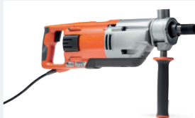
ELÉCTRICO HUSQVARNA DM 220 1850 W, monofásico, diámetro de broca recomendado 150 mm, manual 80 mm, 7,5 kg.
