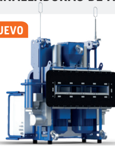
ELÉCTRICO HUSQVARNA BLASTRAC EBE 900VMB 2×22 kW, 400 V, 125 A, velocidad de trabajo 0,5–10 m/min, ancho de trabajo 890 mm, 880 kg.
