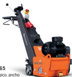
ELÉCTRICO HUSQVARNA BMP 4000RC Control remoto, 30 kW, 400V/63 A, trifásico, ancho de trabajo 400 mm, 1550 kg.
