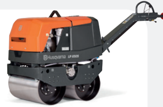
DIÉSEL HUSQVARNA LP 6505 7,2 kW, ancho de tambor 650 mm, 745–765 kg.
