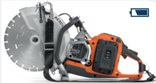
BATERÍA HUSQVARNA K 1 PACE RESCUE 7,9 kg, tamaño de disco 350 mm, profundidad de corte 145 mm. Sistema de batería PACE de 94V.
