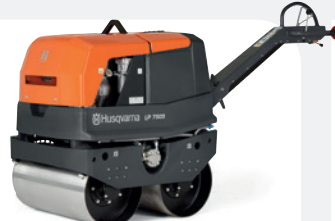
DIÉSEL HUSQVARNA LP 7505 7,9 kW, ancho de tambor 750 mm, 981–1001 kg.
