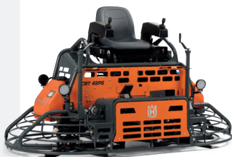
GASOLINA HUSQVARNA CRT 48 PS Ideal para el acabado de superficies de 1000-2300 m². La dirección asistida permite maniobras precisas y un funcionamiento prácticamente sin fatiga con dos modos de control para adaptarse a las preferencias del operador en diferentes condiciones. 42,5 kW, 2×1220 mm, 660 kg.
