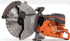
GASOLINA HUSQVARNA K 1270 SMARTGUARD 119 cc, 5,8 kW, 15,1 kg, tamaño de disco 400 mm, profundidad de corte 118/145 mm.
