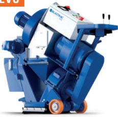
HIDRÁULICO HUSQVARNA BLASTRAC EBE 350S 11 kW, 400 V, 32 A, velocidad de trabajo 1–30 m/min, ancho de trabajo 350 mm, 415 kg.
