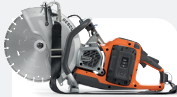
CORTADORA HUSQVARNA K 1 PACE RESCUE 7,9 kg, tamaño de disco 350 mm, profundidad de corte 144,5 mm.
