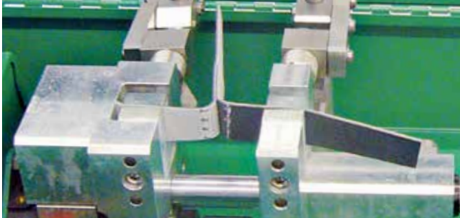
Prueba de un cordón de soldadura con el EXAMO USB.
