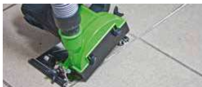
Corte preciso baldosa de gres porcelánico con aspiración
