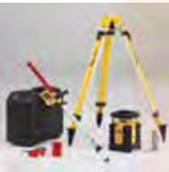
LAR 350, juego de 9 piezas (N.º art. 19111): Roto-láser LAR 350, receptor REC 300 Digital, mando a distancia RC-LAR350, escuadra guía a 90°, gafas de visión láser, placa objetivo, maleta de transporte, trípode para obra BST-S, regla de nivelación NL.
