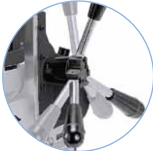
Acionamento do alimentador automático através da manivela
