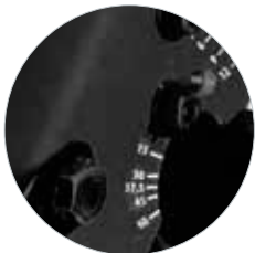
Regulação precisa do ângulo e altura da chanfradura
