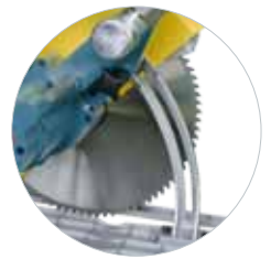
Regulação de profundidade com escala
