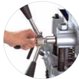
Punho de aperto rápido com possibilidade de montagem em ambos os lados
